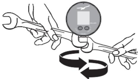
Eine Gegenmutter sichert den Aufnehmer gegen das Gehäuse.
