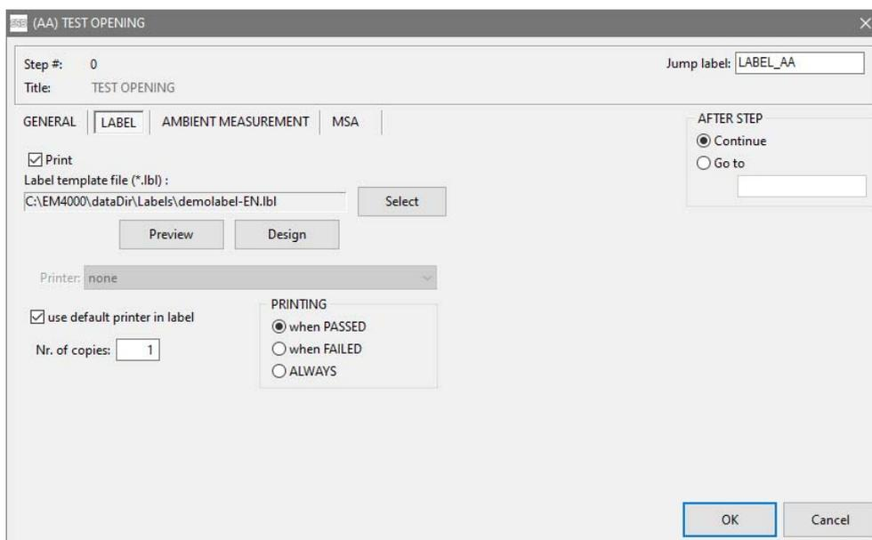
Fig. 39: Test parameters "Label print"
