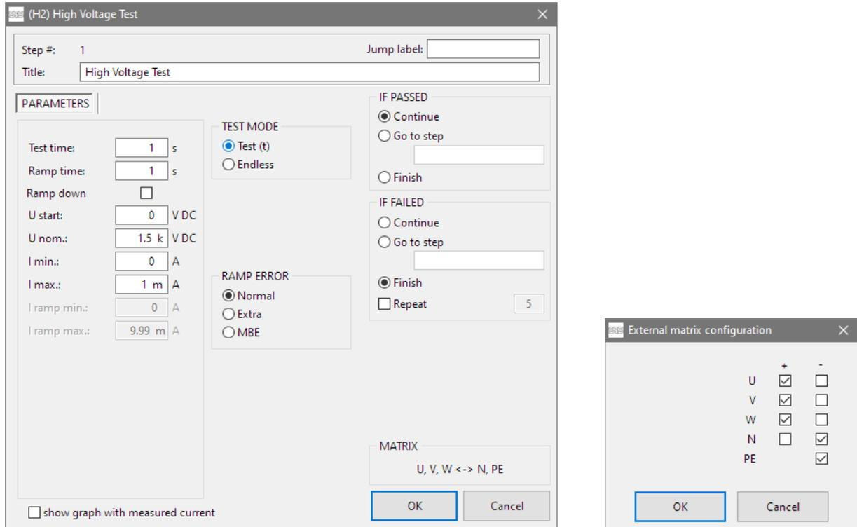
Fig. 49 + 50: Test parameters "High Voltage Test" (H2)
