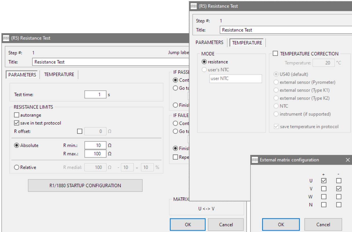
Fig. 44+45: Test parameters "Resistance Test" (R5)
