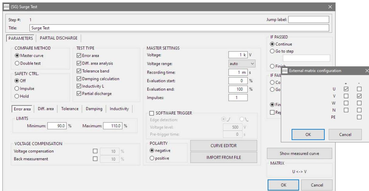
Fig. 51+52: Test parameters "Surge test"
