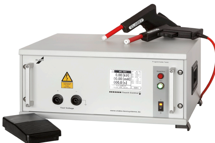
Fig 3.1: Instrument med pekskärm inbyggt i 19 tums/4HE-hölje
